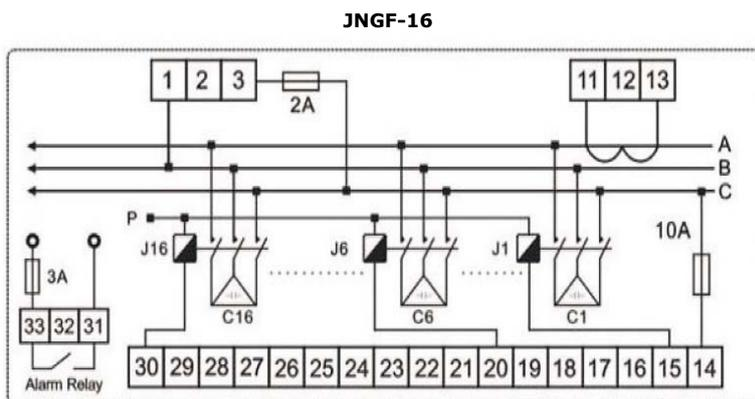
OBSERVAÇÃO: O ponto P deve ser conectado ao B. O TC deve estar em uma fase não utilizada da alimentação do JNGF-16, como exemplo do diagrama acima o JNGF-16 deve estar na fase B e C e o TC instalado na fase A.
